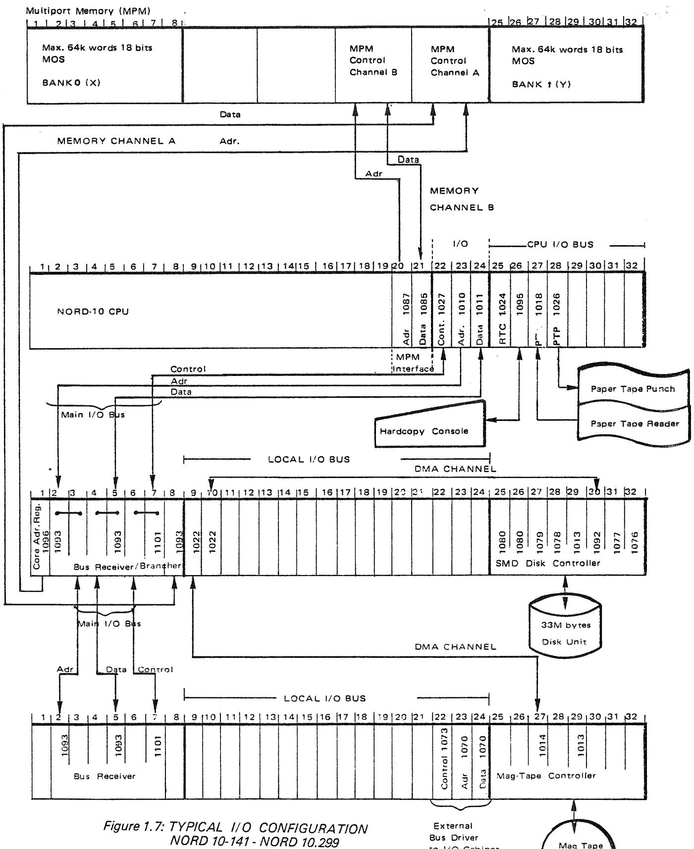
*Figure 1.7: TYPICAL I/O CONFIGURATION
