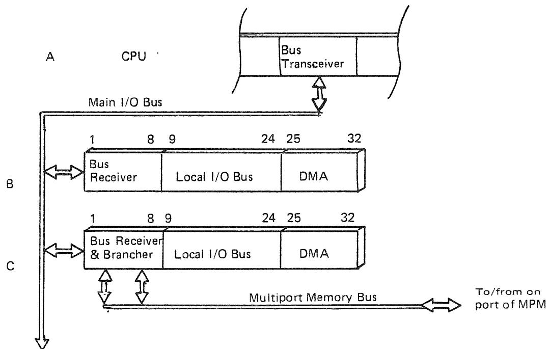
*Figure 1.2: I/O ARCHITECTURE, BLOCK DIAGRAM*
