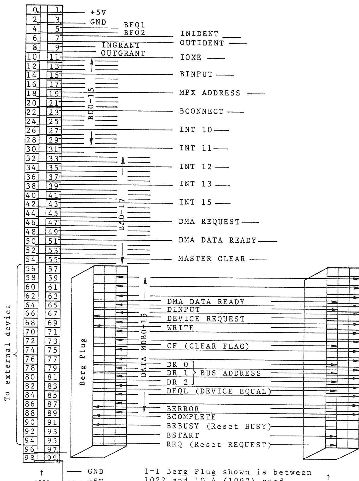
Figure 7.4: SIGNAL DISTRIBUTION I/O BUS B AND C RACK
