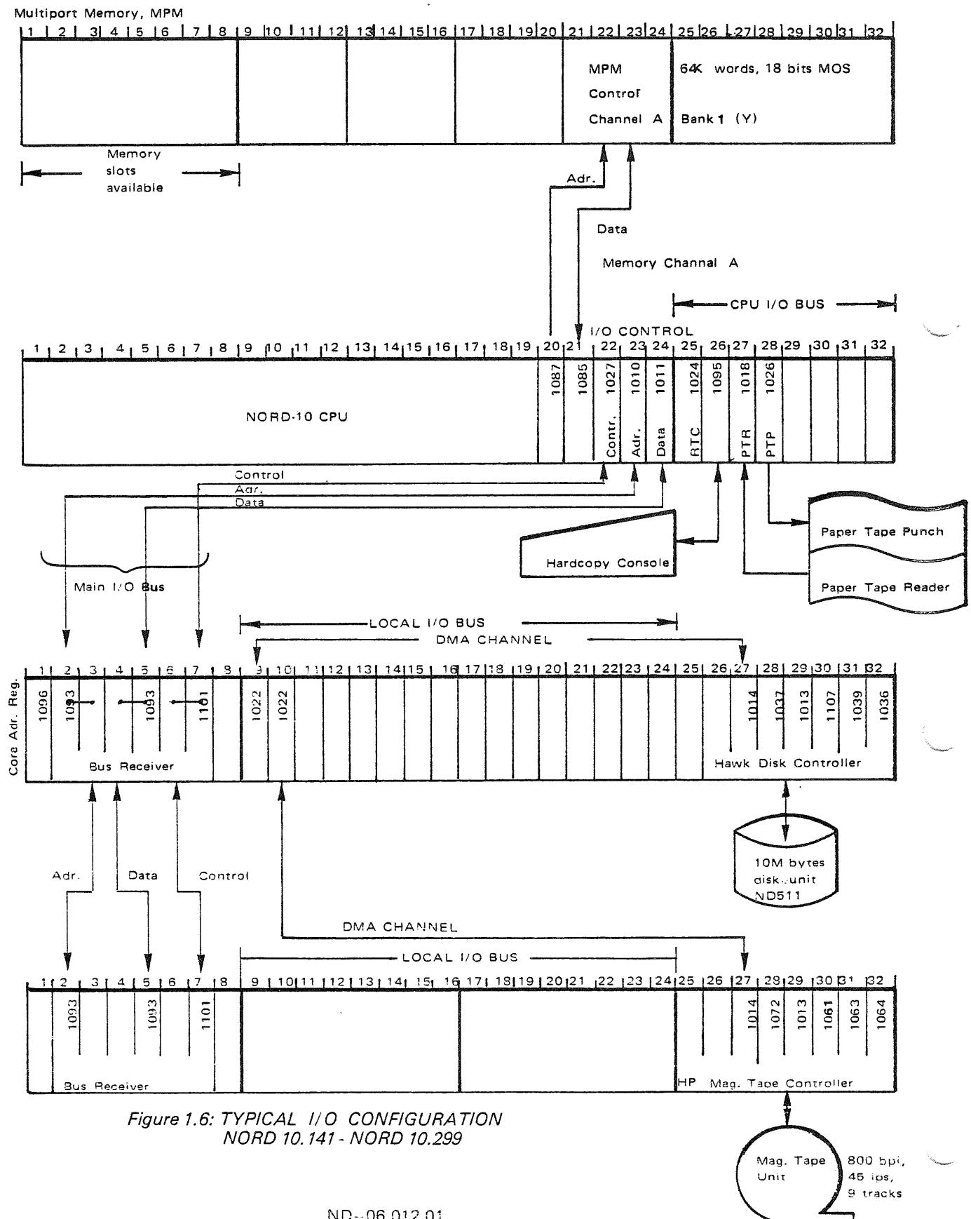
*Figure 1.6: TYPICAL I/O CONFIGURATION
